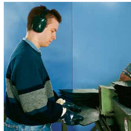
DAS ZURICHTEN - gespaltene Schieferplatten werden hier „in Form“ gebracht und erhalten die richtigen Abmessungen.
