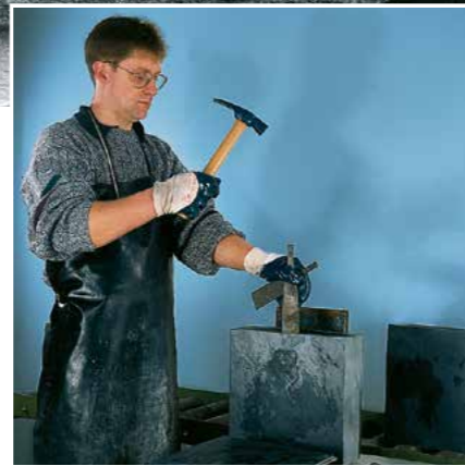
DAS SPALTEN - der in Schichten aufgebaute Schiefer wird sorgfältig in entsprechender Stärke gespalten.
